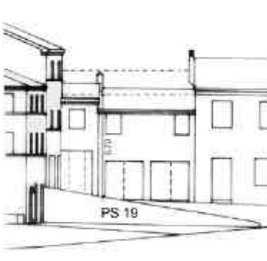
19) U.U.E.E. via B.go S. Giovanni n. 52 – 54 (part. cat. 115 – 111). Ripristino delle originarie bucatore. Eliminazione tapparelle a serranda in lamiera zincata da sostituire con elementi in legno trattato al trasparente opaco oppure verniciati.
